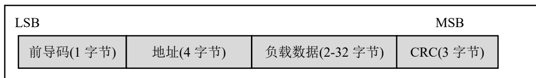
图 4-4 BLE-蓝牙数据包格式
