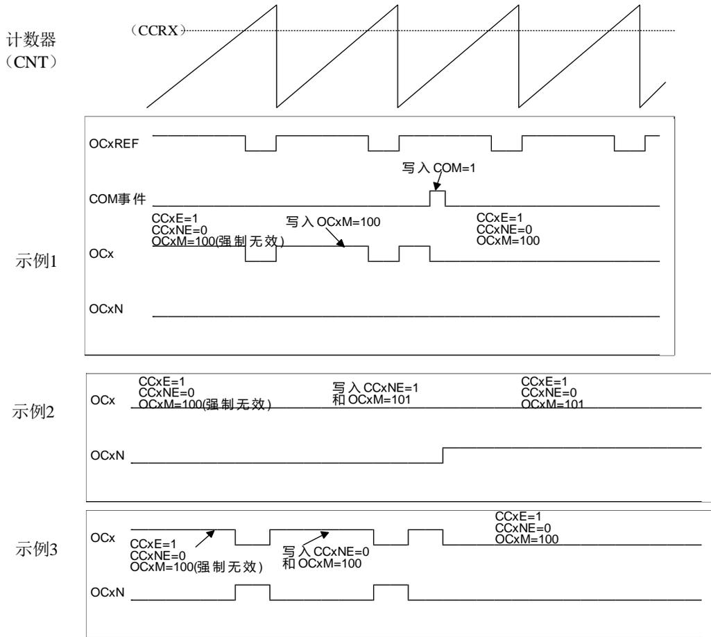
图 2-36 产生六步 PWM，使用 COM 的例子 (OSSR=1)
