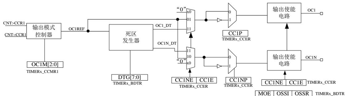
**图 2-27 捕获/比较通道的输出部分**
