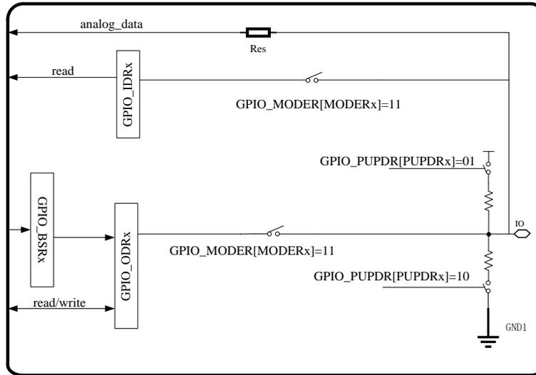
图 2-5 GPIO 模拟功能配置原理图
