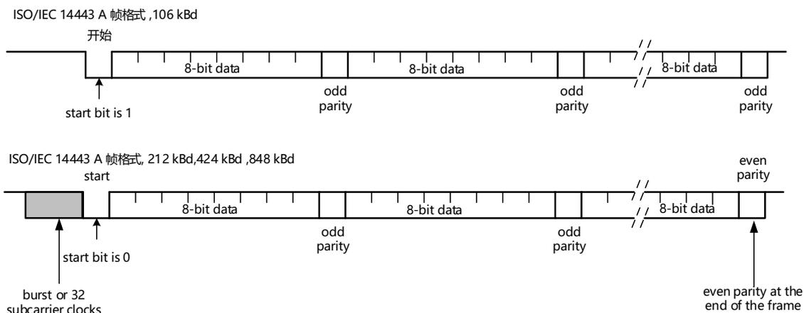
图 3-1 ISO/IEC 14443 A 协议的数据编码和帧格式
