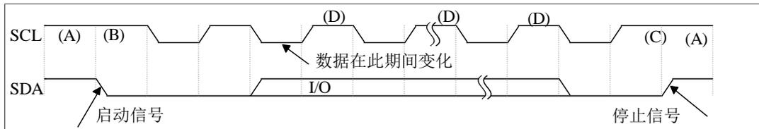
图 2-44 I2C 二线制串行总线
