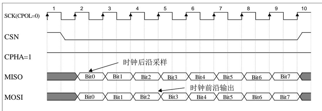
图 2-50 spi 模式 1 时序图
