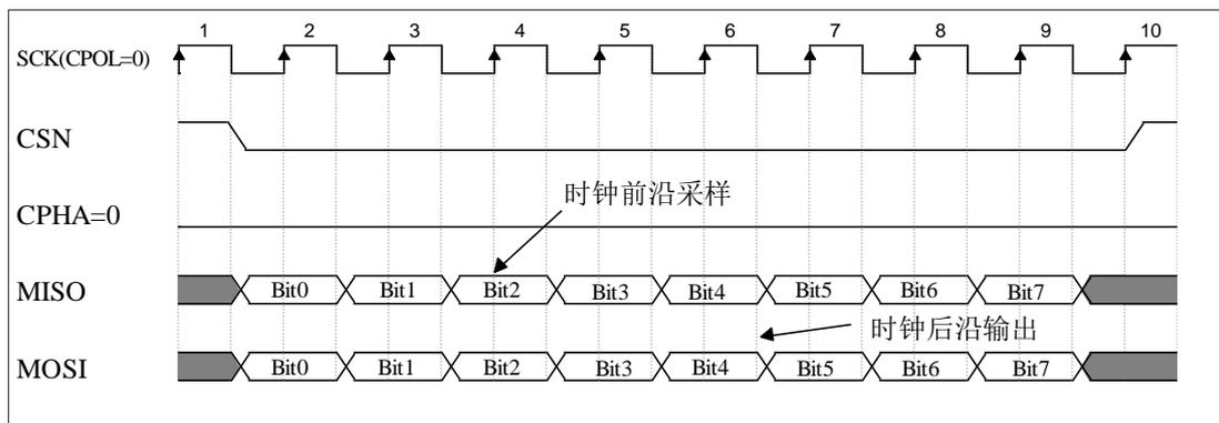
图 2-49 spi 模式 0 时序图
