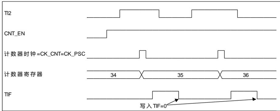
图 2-25 外部时钟模式 1 下的控制电路
