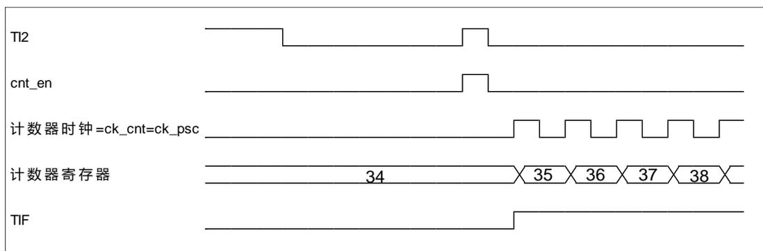
图 2-41 触发器模式下的控制电路
