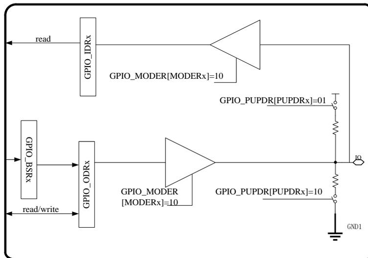
图 2-4 GPIO 复用功能配置原理图
