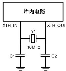
图 4-3 使用 16 MHz 晶振时典型应用图
