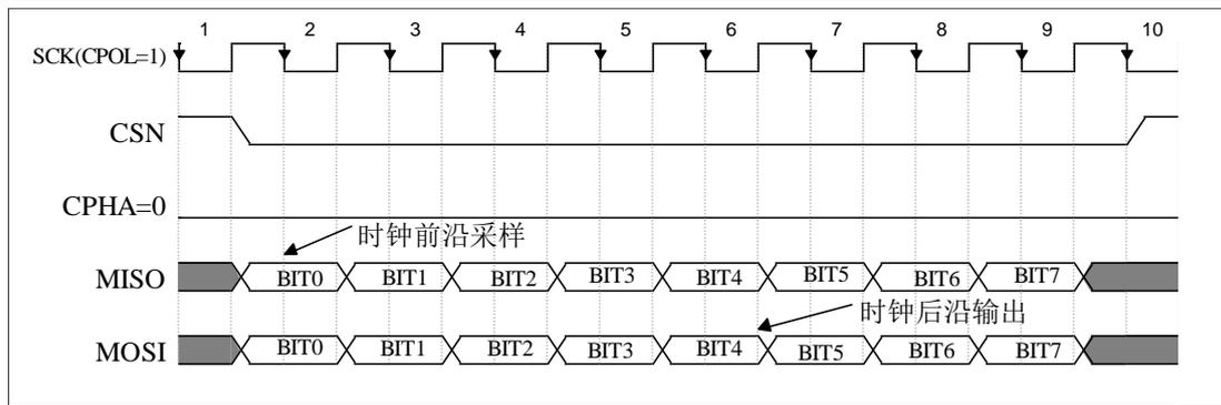
图 2-51 spi 模式 2 时序图
