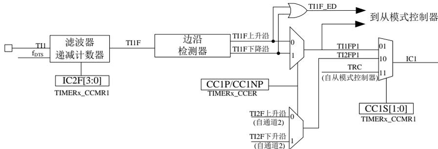
图 2-26 捕获/比较通道（通道 1 输入部分）
