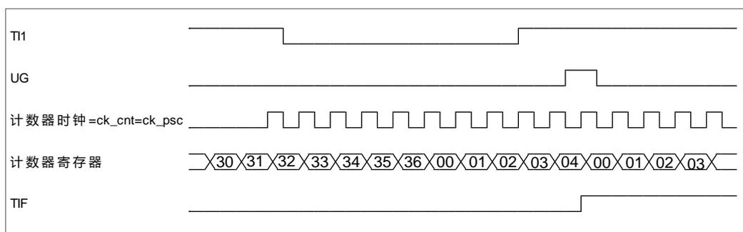
图 2-39 复位模式下的控制电路
