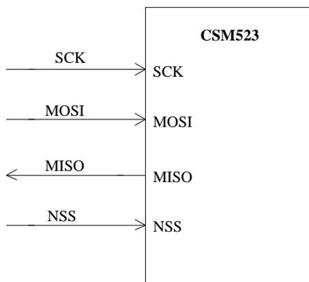
图 3-2 SPI 连接主机
