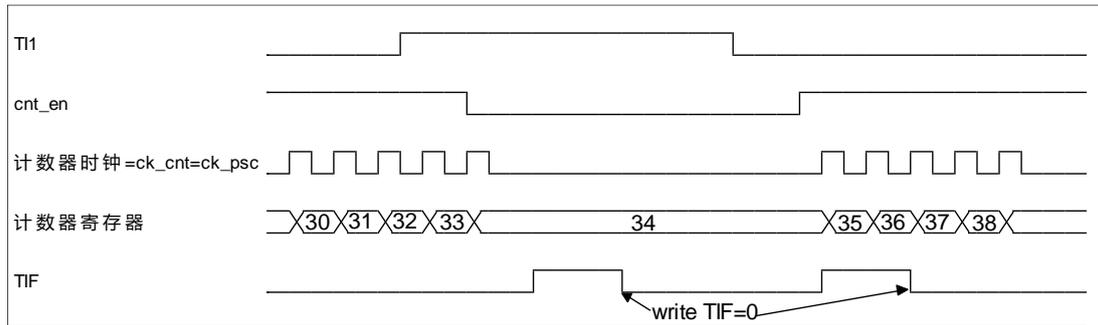
图 2-40 门控模式下的控制电路
