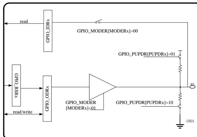
图 2-3 GPIO 输出配置原理图
