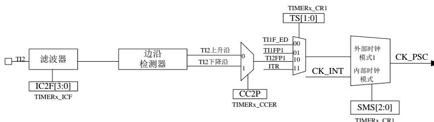
图 2-24 TI2 外部时钟连接例子
