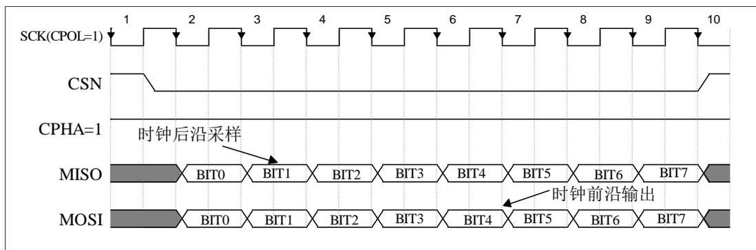
图 2-52 spi 模式 3 时序图
