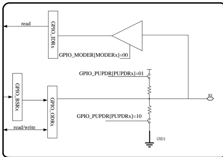
图 2-2 GPIO 输入配置原理图
