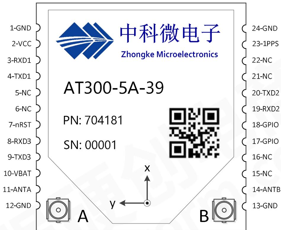
图 3.1 外观管脚图, 5A37 与 5A39 管脚定义一致
